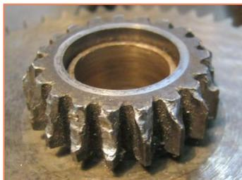
Эксплуатация зубчатых передач со временем может приводить к появлению локальных или более масштабных разрушений зубьев, к чему можно отнести пластическую деформацию рабочих поверхностей, их поломку, изнашивание, заедание, выкрашивание рабочих поверхностей.
