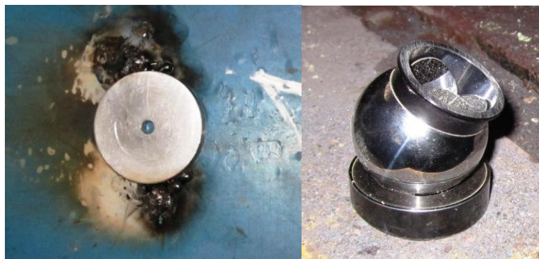
Рис.1 Площадка под оснастку и установленный на площадке отражатель с оснасткой.
