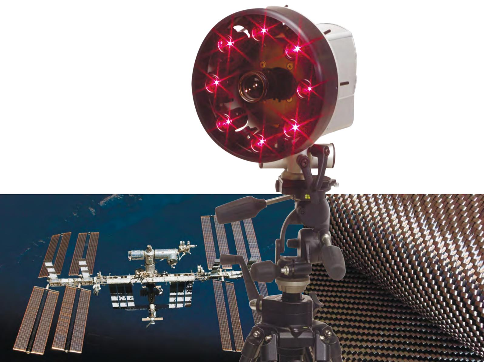
**Шерография. Неразрушающий контроль
