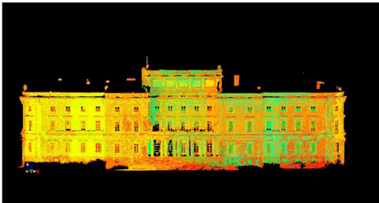
Облако точек измерений фасада
