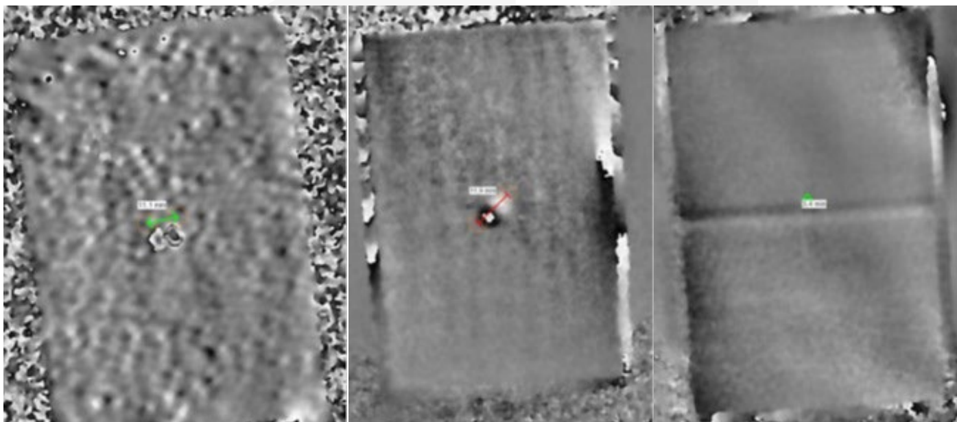
Шерограмма сотопанелей с заложенным внутренним дефектом – фторопластовой пленкой, выступающей в качестве имитатора непроклея обшивки к сотоблоку
