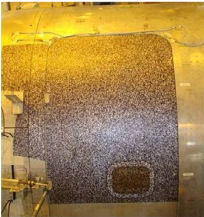
Спекл-структура, нанесенная на люк фюзеляжа
